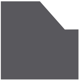
EDGE CHAMFERED EDGE DETAIL
