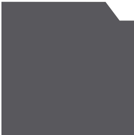
EDGE MICRO BEVEL DETAIL
